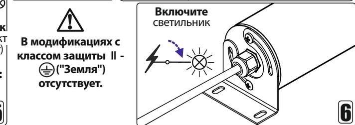
В модификациях с дополнительным выводом (димминг, АБ) соответствующий провод светильника имеет этикетку с цветовой маркировкой сигналов управления и его подключение необходимо производить согласно информации на ней.
